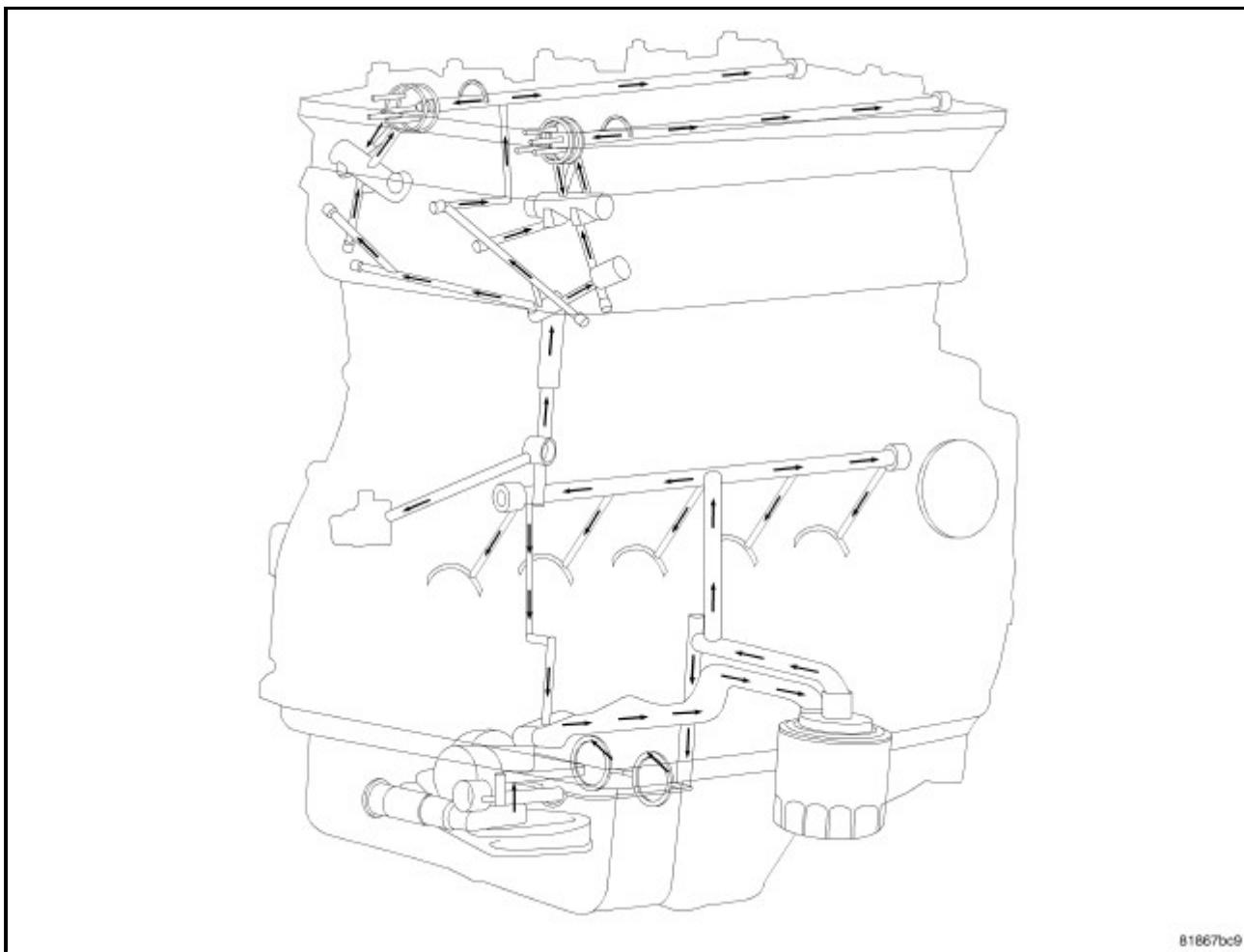
润滑系统为全流过滤压力供给式。平衡轴模块(BSM)安装在梯形框架和由曲轴驱动的链条下面。BSM由不可保养的泵、油压卸压阀和不可保养的平衡总成组成。
